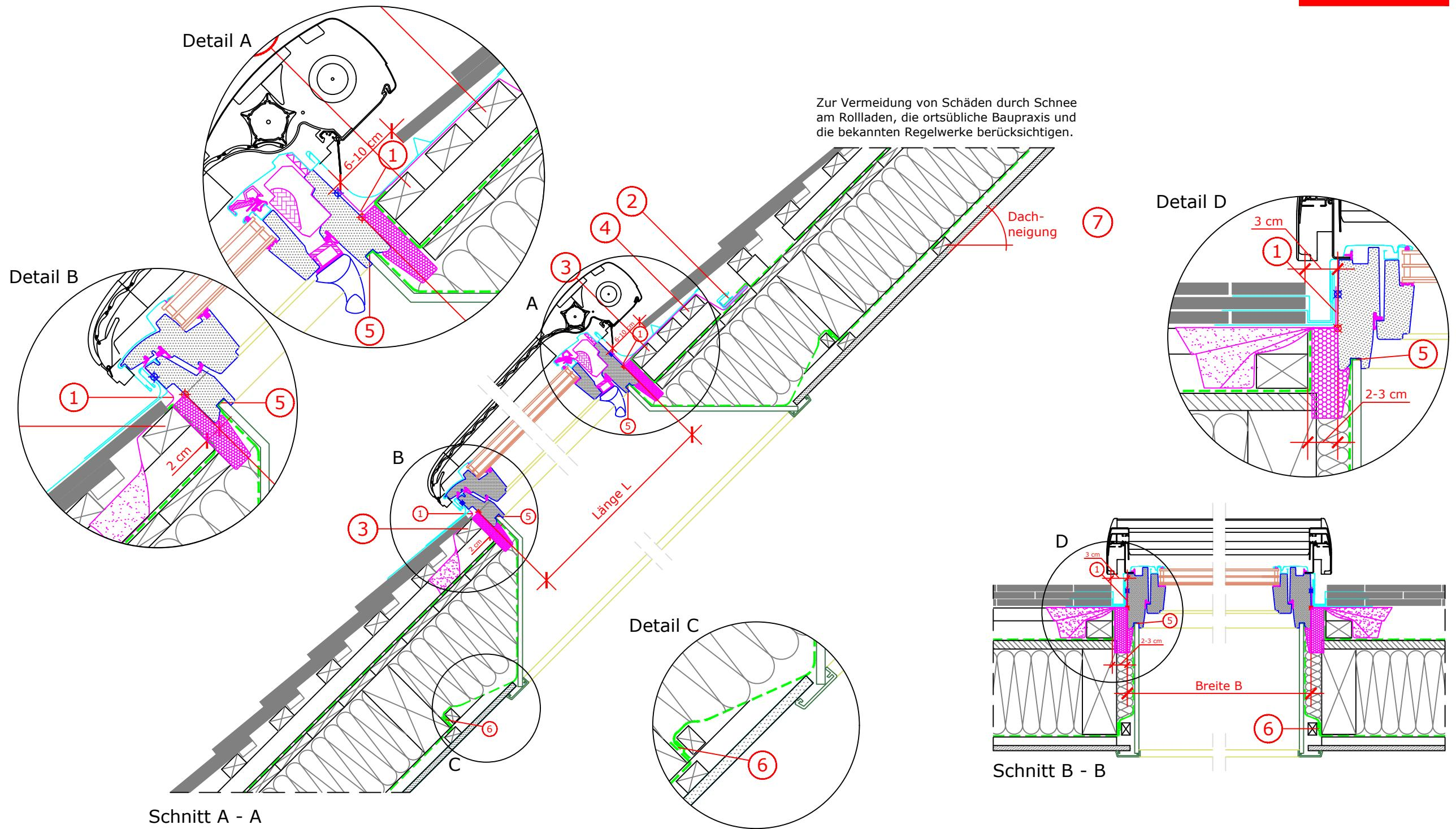
1. Nach Montage des Wärmedämmrahmens BDX und des Fensters, beiliegende Unterdachschürze BBX anbringen.
